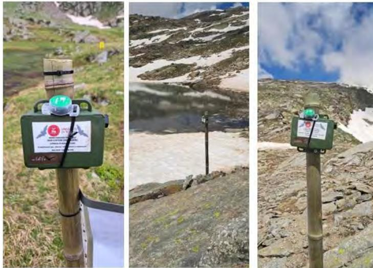
**Figura 7.27** Posizionamento dei bat detector Wildlife Acoustics Song Meter Mini Bat su pali tramite l'utilizzo di fascette e viti, con logger di temperatura HOBO MX2202.
